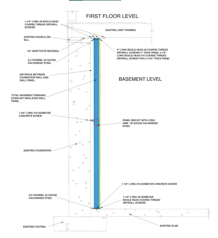
FIGURE 1 DETAILS FOR EVERLAST BASEMENT WALL PANEL SYSTEM™
