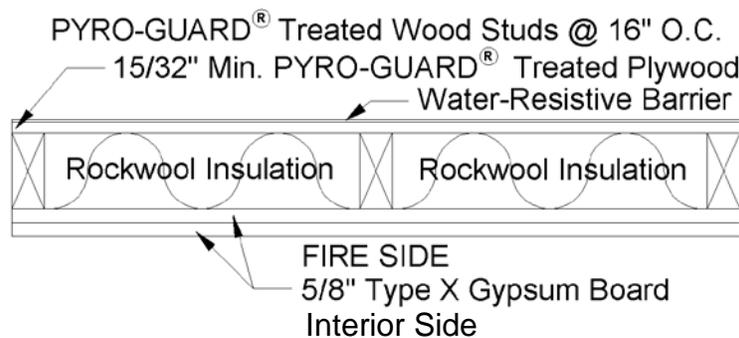
**FIGURE 3—2-HOUR FIRE-RESISTANCE-RATED EXTERIOR WALL ASSEMBLY**
