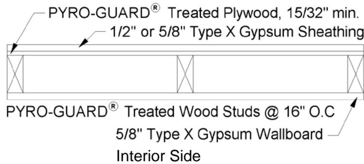
**FIGURE 4—1-HOUR FIRE-RESISTANCE-RATED EXTERIOR WALL ASSEMBLY**
