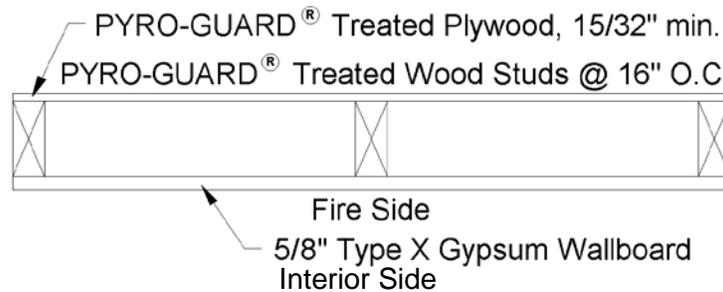
**FIGURE 5—1-HOUR FIRE-RESISTANCE-RATED EXTERIOR WALL ASSEMBLY**
