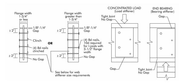
FIGURE 2—PRI I-JOIST WEB STIFFENER CONSTRUCTION DETAILS
