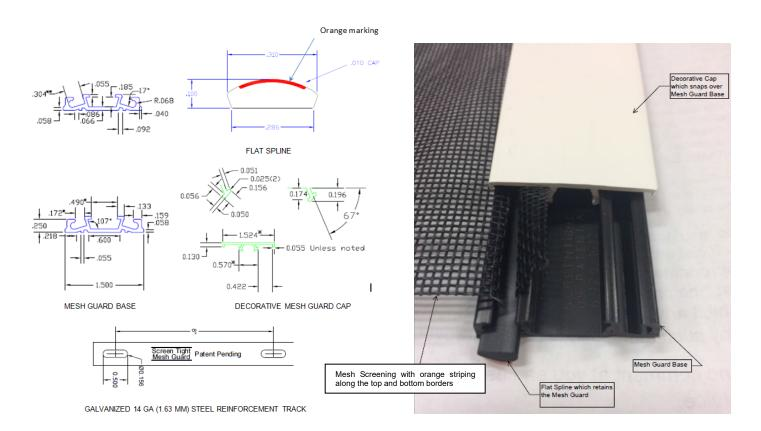
FIGURE 1-MESH GUARD SYSTEM
